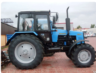
Колесный трактор МТЗ - 1221.2 Беларус с газобаллонным оборудо
