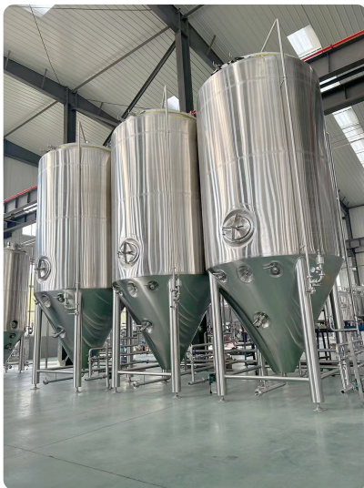
Конический ферментер из нержавеющей стали объемом 60 барреле
